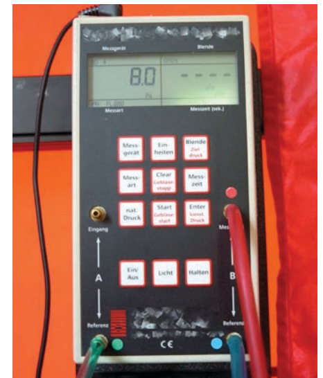
(5) Die Messung der natürlichen Druckdifferenz bei geschlossenem Gebläse liefert wertvolle Hinweise v. a. bei Leckagen, die sich im oberen Teil des Gebäudes befinden. Zeigt das Messgerät mehr als 5 Pascal, wird die Messung nach Norm nicht durchgeführt.
