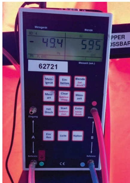
(4) Das Messgerät zeigt links den Gebäudedruck in Pascal und rechts den Volumenstrom bezogen auf 50 Pascal. Geteilt durch 2 ergibt das in etwa die äquivalente Leckagefläche in Quadratzentimetern.
