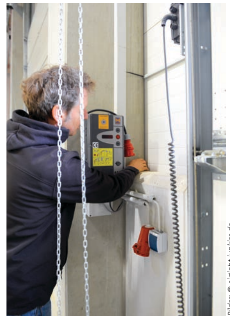
(6) Luftströmungen sind gut mit der Hand fühlbar. Oft finden sich Leckagen an den Bauteilübergängen zwischen verschiedenen Materialien – hier bei der Messung einer Halle.
