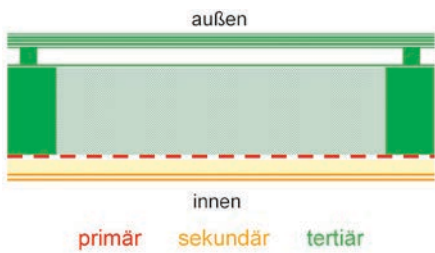
(2) Die Wahl der Mittel zur Leckagesuche hängt auch von ihrer Lage zur vorgesehenen luftdichten Ebene ab. Eine primäre Leckage betrifft direkt die luftdichte Ebene, die sekundären werden auch als Lufttrittsstellen bezeichnet.
