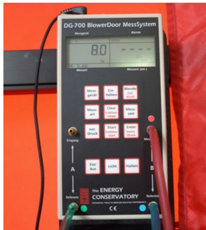
Die natürliche Druckdifferenz bei geschlossenem Gebläse darf 5 Pascal nicht überschreiten. Hier werden 8 Pascal angezeigt.
